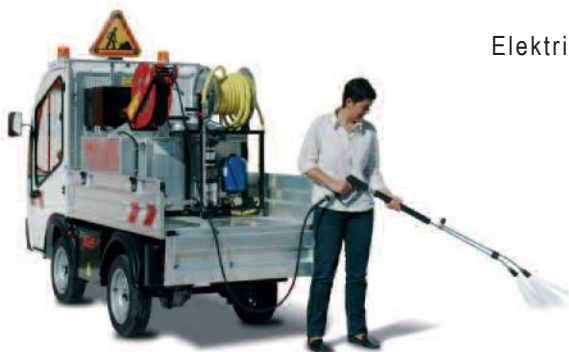
Visoko tlačni čistilec v kombinaciji z sistemom za zalivanje
