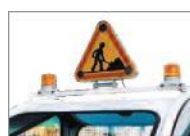
Delo na cesti, Led Trikotnik (AK5) na strehi
